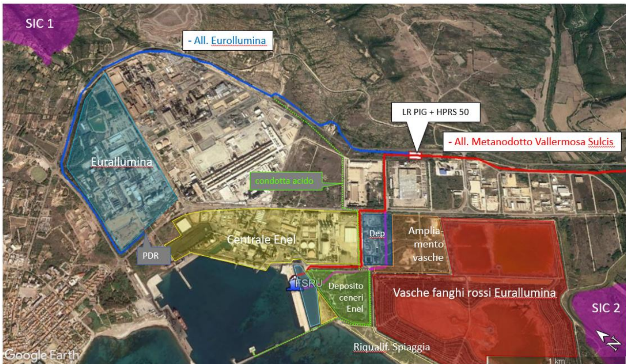
Figura 1-1 – Schema distribuzione gas Portovesme
