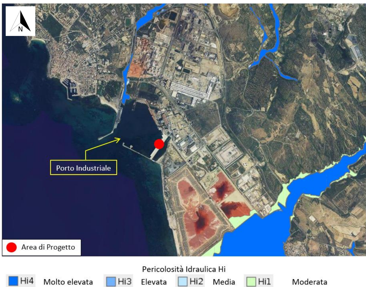
Figura 3-5: PAI - Pericolosità Idraulica
