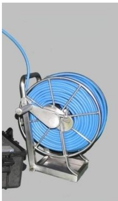
Figura 6-3 - La videocamera trainata utilizzata per il rilievo a Portovesme (a sinistra) e il rullo con il cavo di traino / trasmissione del segnale
