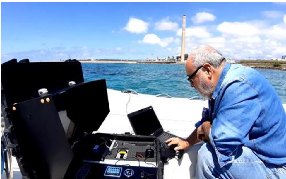
Figura 6-4 - Operatore al monitor di controllo della videocamera trainata
