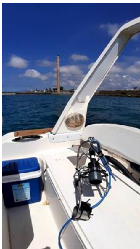
Figura 6-3 - La videocamera trainata utilizzata per il rilievo a Portovesme (a sinistra) e il rullo con il cavo di traino / trasmissione del segnale
