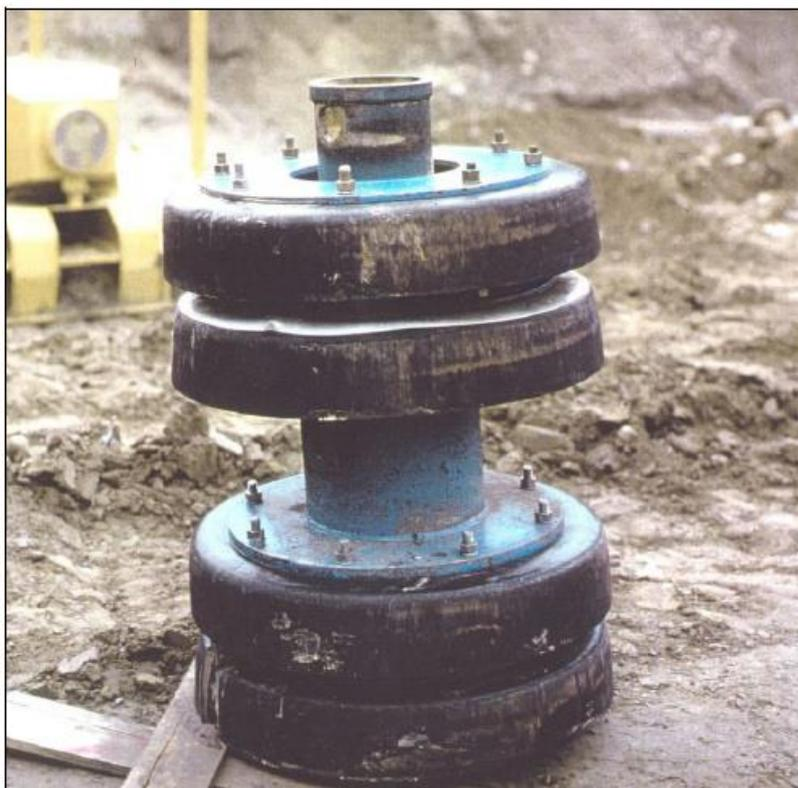
**Figura 3.3.8.2/A: Pig convenzionale impiegato nelle operazioni di collaudo idraulico e di pulizia della condotta**
