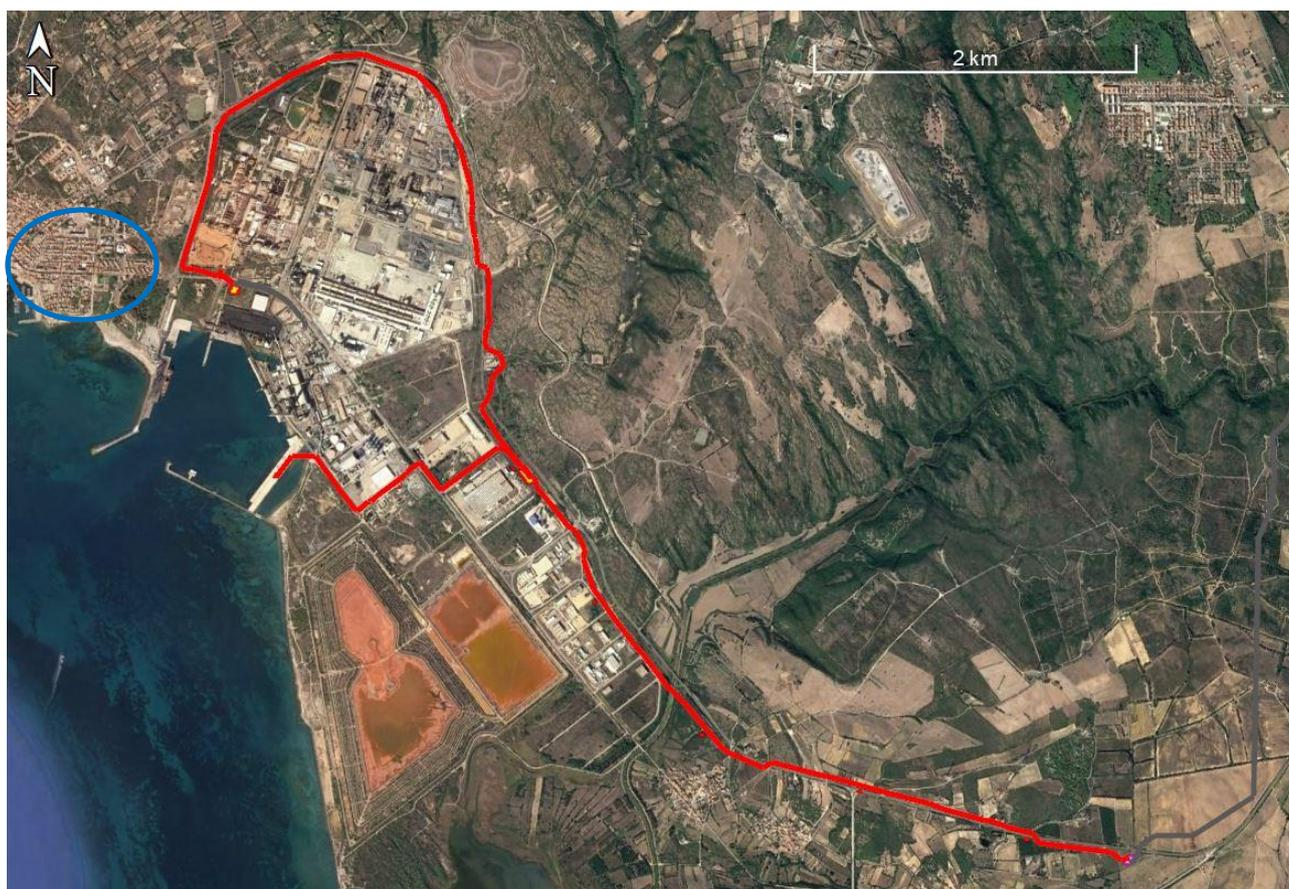
**Figura 5.9.3/A: Abitato di Portoscuso in blu e in rosso metanodotto Derivazione per Portoscuso DN 400 (16''), DP 75 bar**
