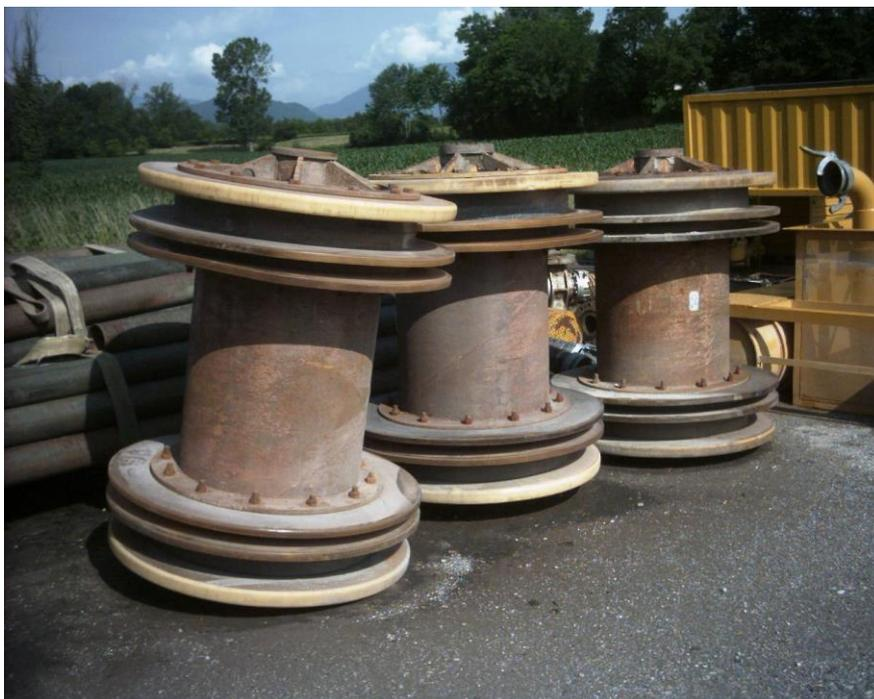
**Figura 3.3.7.1/B: Pig per collaudo idraulico**
