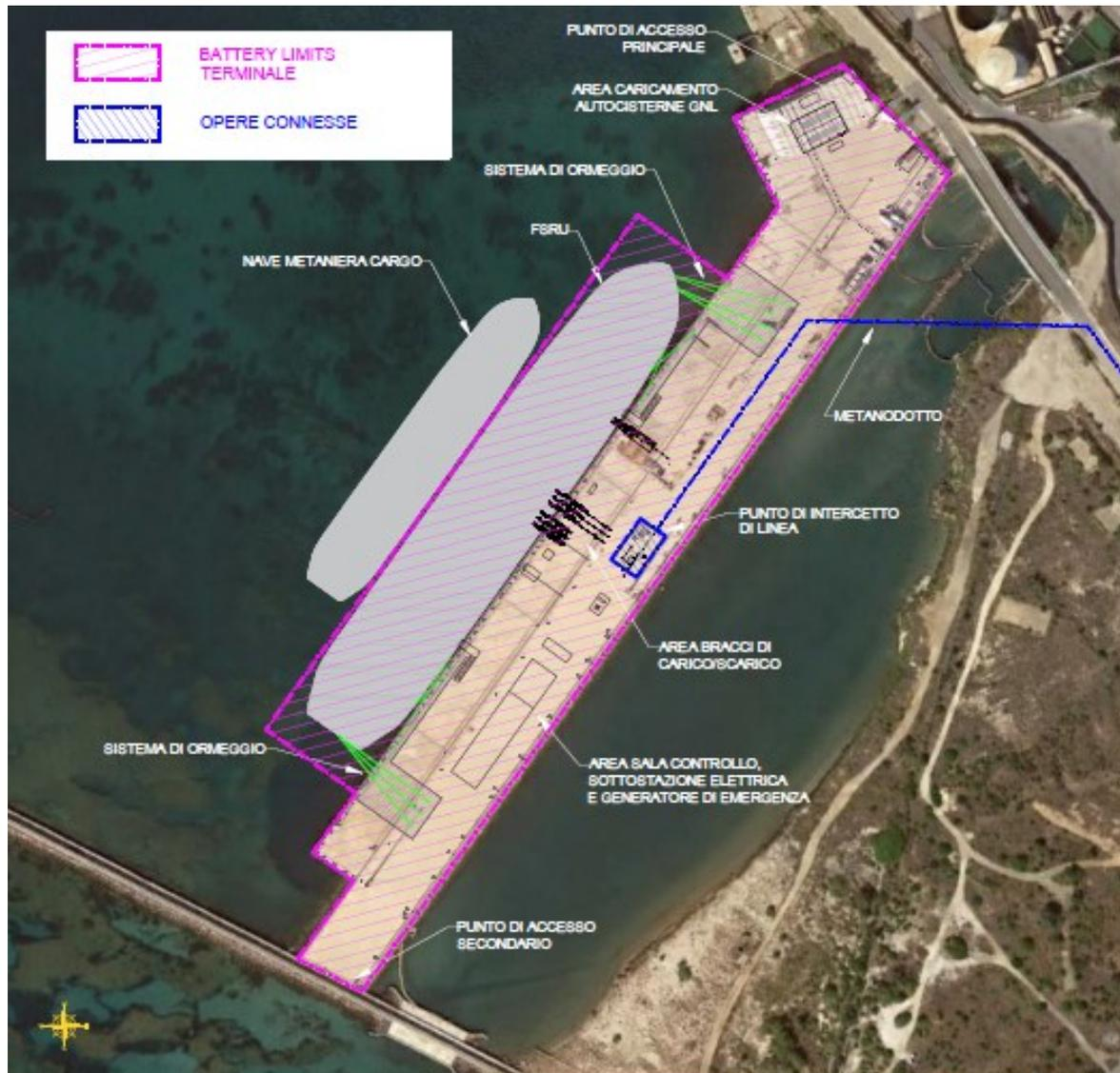
**Figura 1-1: Layout e Battery Limits del Terminale di Portovesme**
