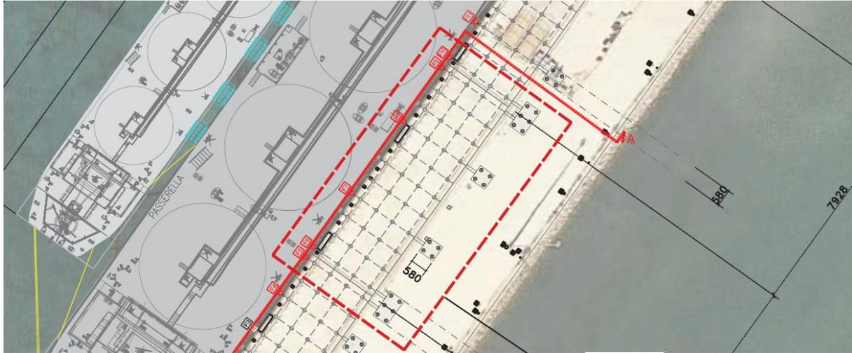
**Figura 4-3: Layout dei plinti del sistema di rinforzo fender**
