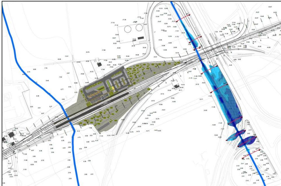
**Figura 28 - Aree di esondazione dell'opera di attraversamento IN01**
