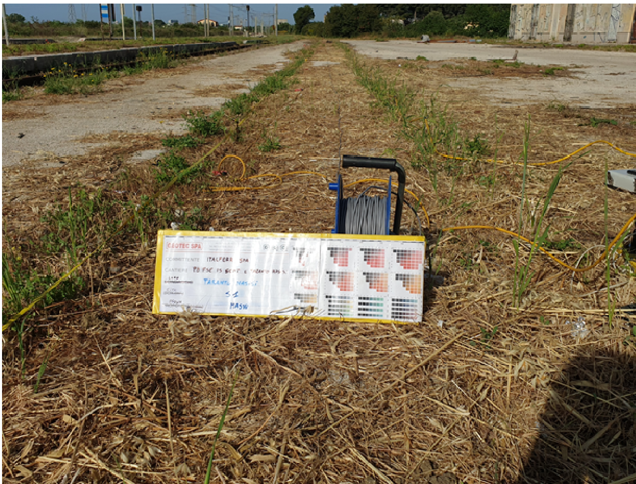
Fig. 2 - Stendimento sismico con acquisizione prova di tipo MASW
