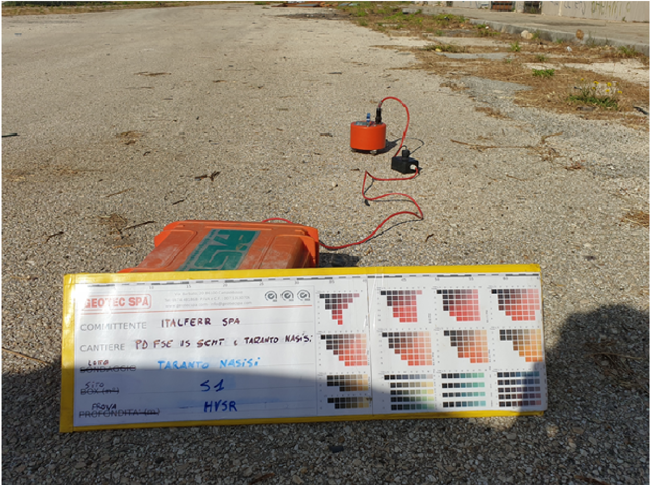
Fig. 3 - Stazione singola (HVSr)
