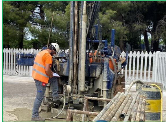
Figura 6: Esecuzione prova Lefranc
