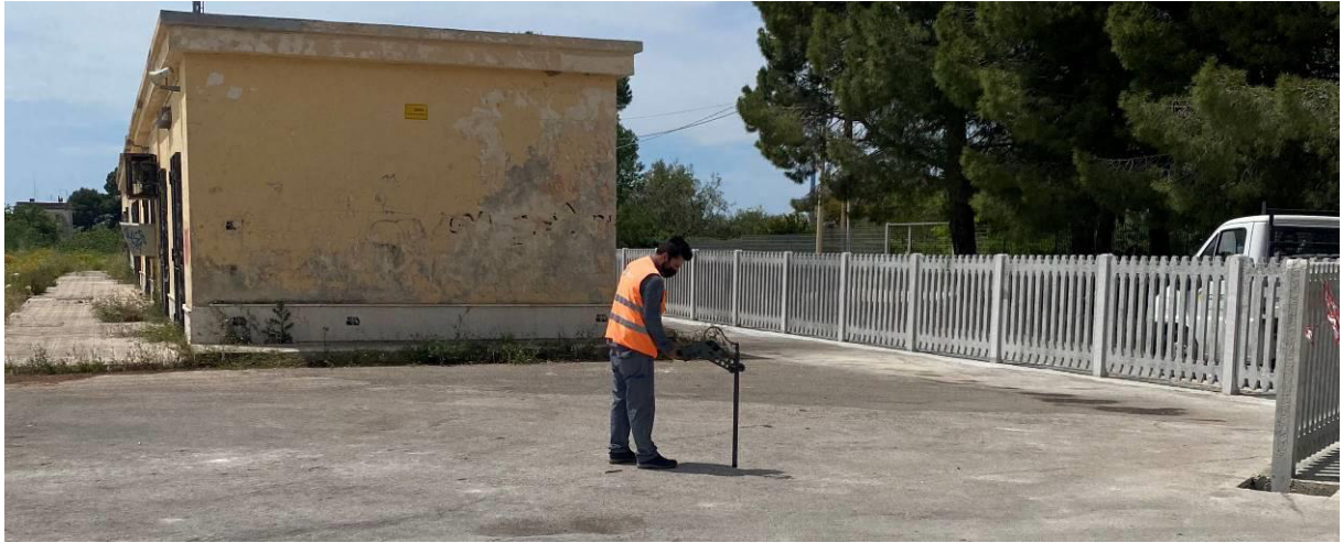
Postazione: ante sondaggio, ispezione area con Foerster Ferex .
