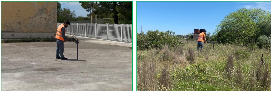
Figura 9: Ispezione aree di indagine con "Foerster Ferex 4032".
