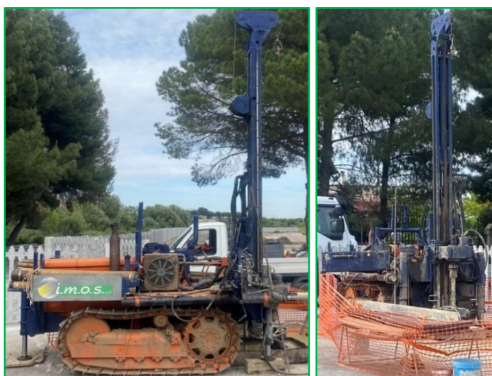
Figura 2: Macchina perforatrice utilizzata
