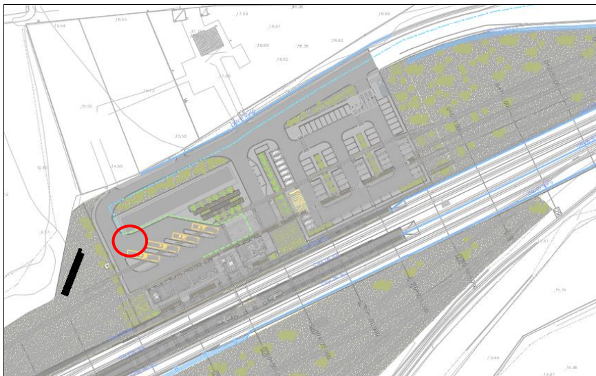
Rappresentazione della rete di adduzione idrica (linea tratteggiata verde) con il punto di allaccio (cerchio rosso)
