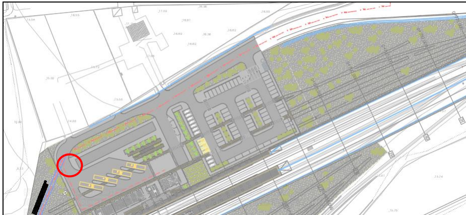
Rappresentazione della rete fognaria (linea tratteggiata rossa) con il punto di scarico (cerchio rosso)
