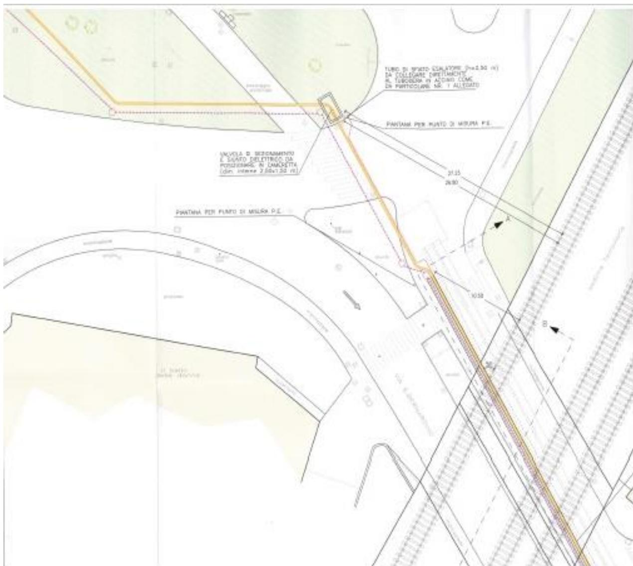
Note e caratteristiche del sottoservizio: Attraversamento con Metanodotto
