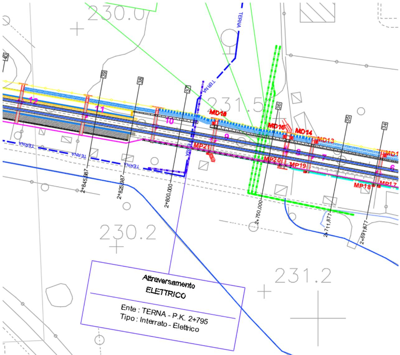
Note e caratteristiche del sottoservizio: Attraversamento realizzato con un tubo in acciaio dal diametro di 800mm, contenente cavi elettrici per telecomando.
