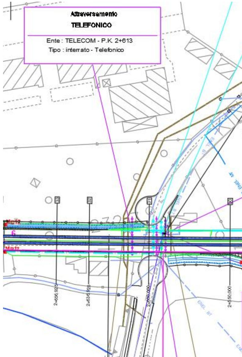
Note e caratteristiche del sottoservizio: attraversamento TELECOMUNICAZIONI sotterraneo
