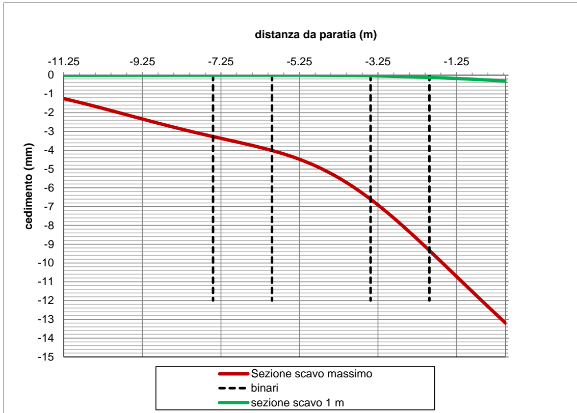
Figura 5: andamento dei cedimenti a tergo dell'opera di sostegno
