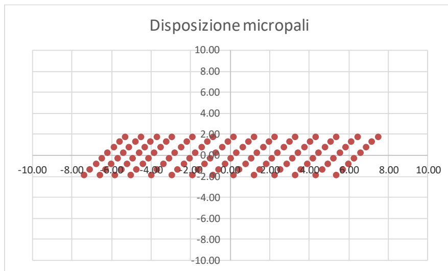
Figura 6-35 - disposizione dei micropali di fondazione
