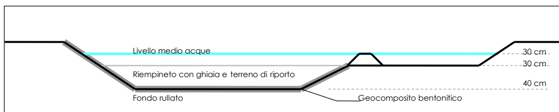
Sezione schematica del sistema di fitodepurazione
