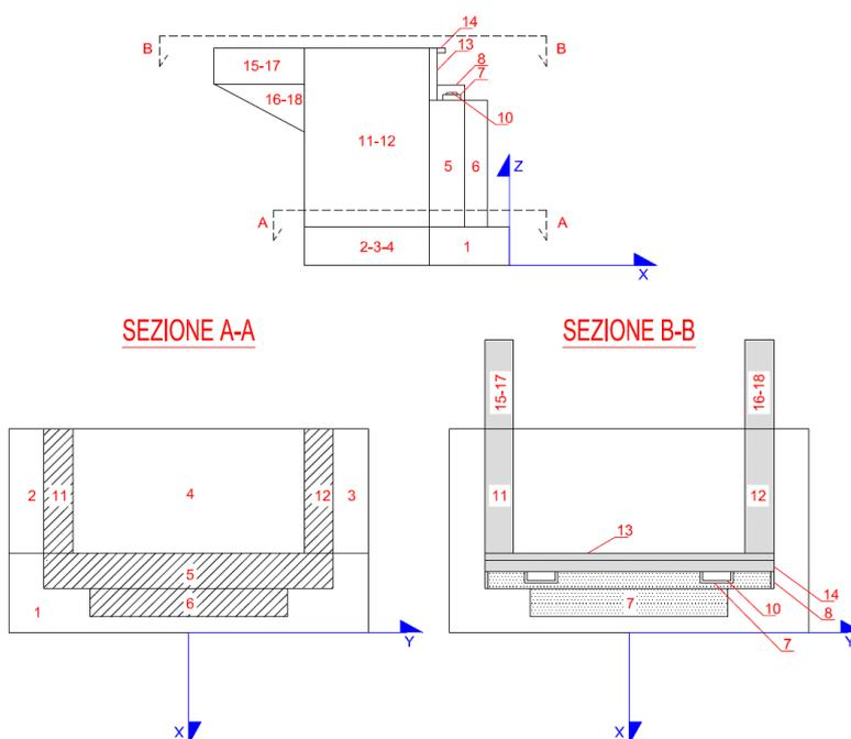
Figura 6-4: Schema qualitativo della geometria della spalla
