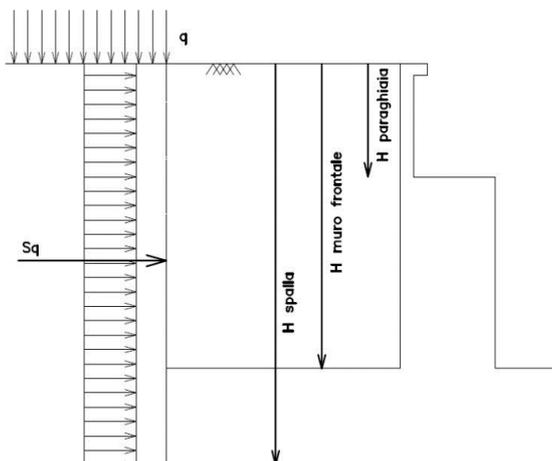
Figura 6-19: Schema per il calcolo degli effetti della spinta dovuta al sovraccarico accidentale
