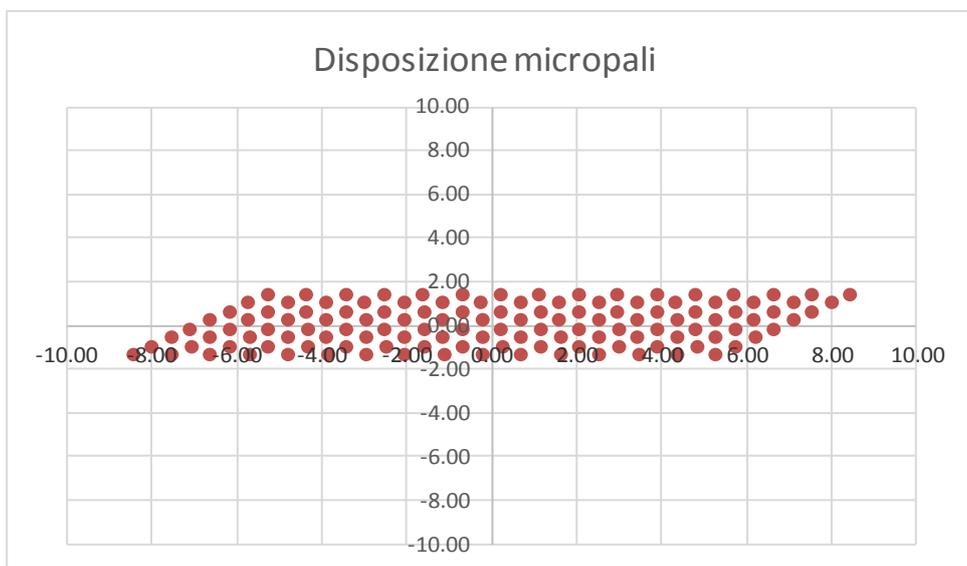
Figura 6-35 - disposizione dei pali di fondazione
