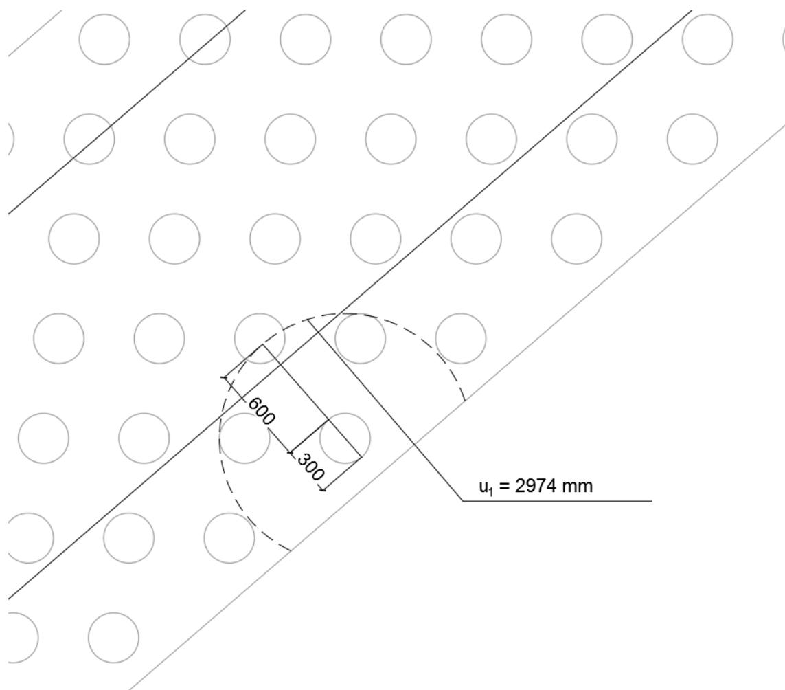
Figura 6-40: Schema per la scelta del perimetro di verifica
