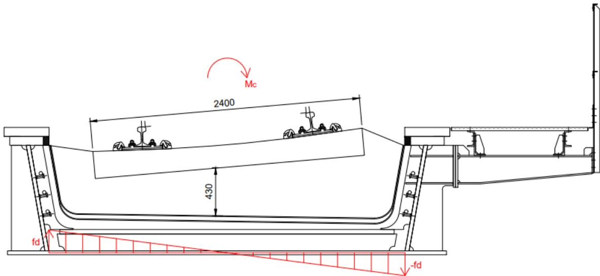
Figura 6-14: Schema di applicazione della forza centrifuga: momento torcente
