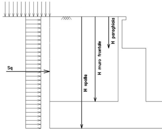
*Figura 6-27 - Schema per il calcolo degli effetti della spinta dovuta al sovraccarico accidentale*
