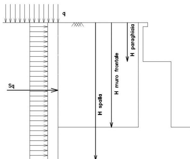
Figura 6-17: Schema per il calcolo degli effetti della spinta dovuta al sovraccarico accidentale
