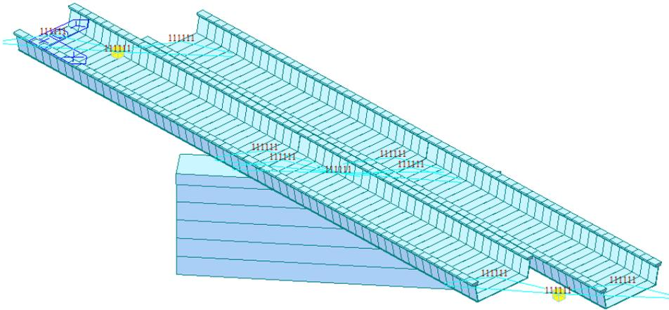
*Figura 6-9: modello di calcolo per la valutazione dei carichi provenienti dall'impalcato*
