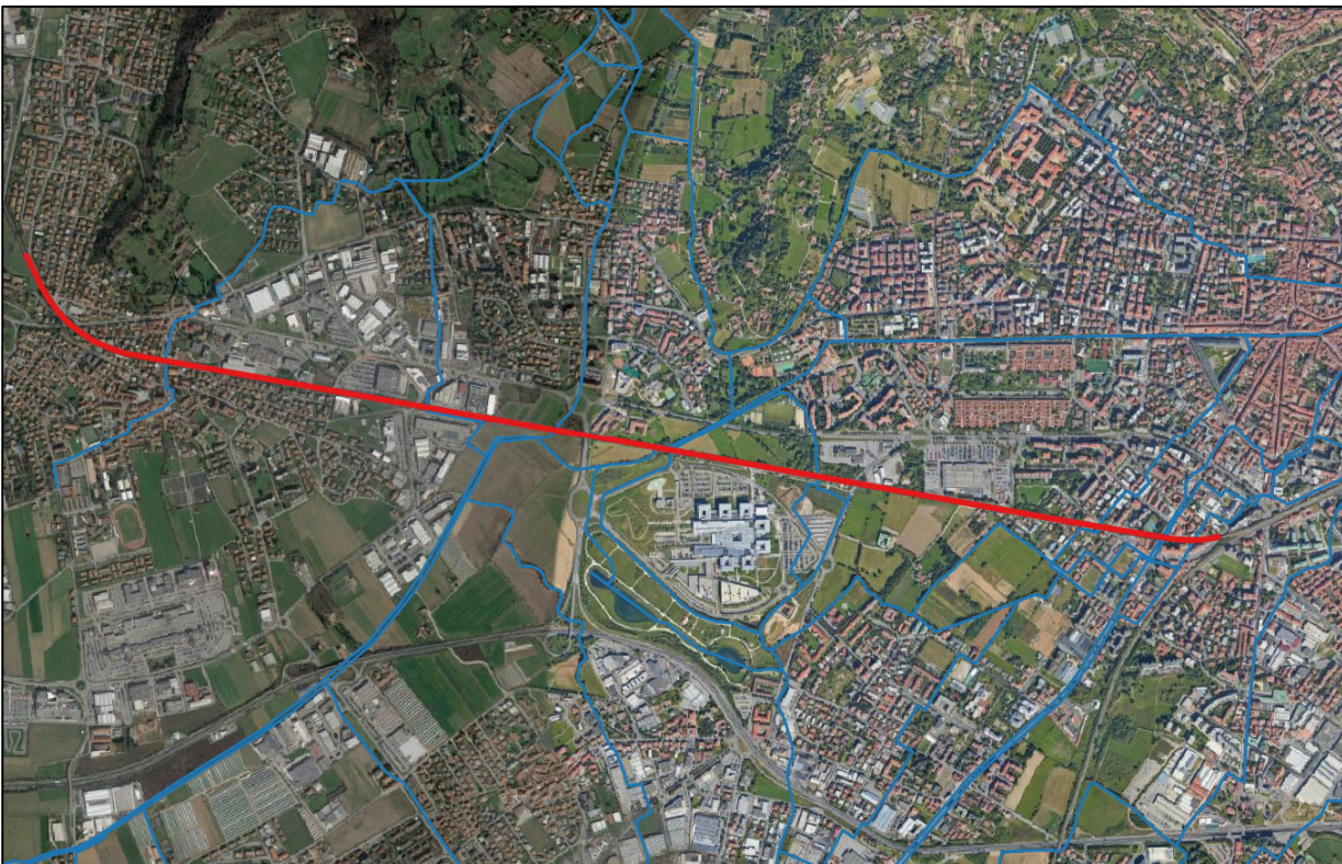
Figura 3.2 - Intersezioni con canali irrigui.
