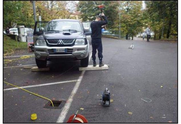
INDAGINE SISMICA Profilo Sismico a Rifrazione P e S (*Energizzazione Onde P a sinistra e Onde S a destra*).
