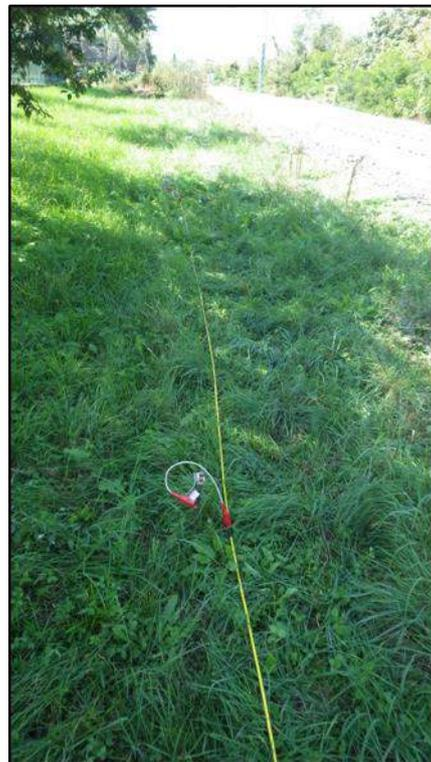
INDAGINE SISMICA Prova Re.Mi/MASW e HVSR (*Energizzazione prova MASW a sinistra e Tromografo a destra*).
