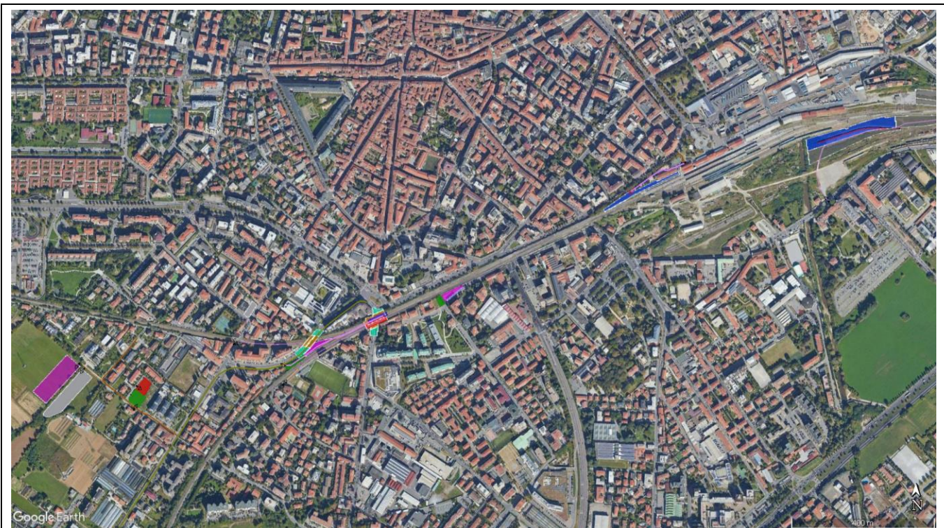
Vista aerea ubicazione Campo Base (rosso) Cantiere operativo (verde), Cantiere armamento e tecnologia (blu) e Aree di Stoccaggio (viola)
