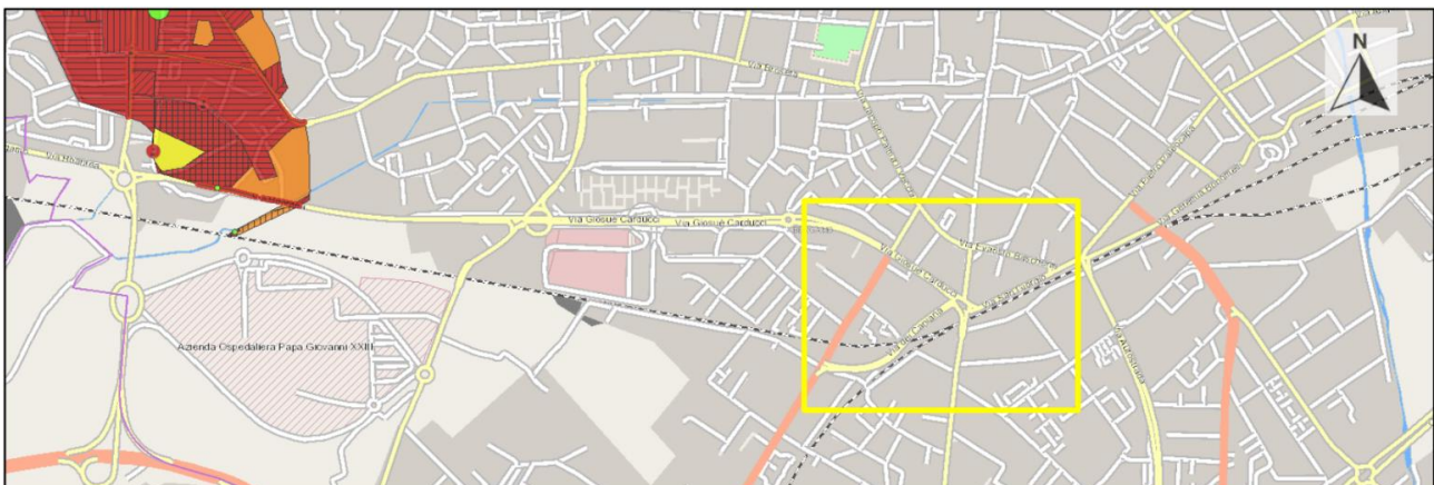
Figura 23 Stralcio della cartografia del rischio idraulico (Direttiva alluvioni 2007/60/CE - Revisione 2019), area di Bergamo e nel riquadro in giallo l'area oggetto del presente progetto.
