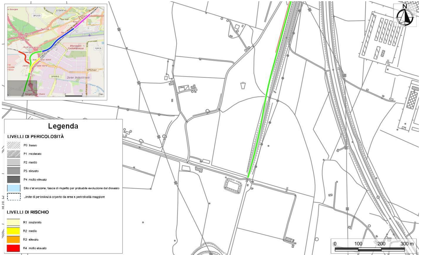
Figura 44 - Stralcio della Carta della pericolosità e del rischio geomorfologico del Piano Stralcio di Assetto Idrogeologico della Regione Sicilia (2005 con aggiornamento 2019 – 095 Area Territoriale tra i bacini del F. Simeto e del F. Alcantara e 094 Bacino idrografico del Fiume Simeto), con individuazione delle tratte ferroviarie in progetto (in magenta la tratta relativa al lotto “Stazione di Fontanarossa”, in blu la tratta relativa al lotto “Interramento linea Palermo-Catania”, in verde la tratta relativa al lotto “Bretella Catania-Siracusa”, in rosso la tratta relativa al lotto “Bretella Palermo-Siracusa”, in giallo la tratta relativa al lotto “Collegamento dal fascio A/P al Terminal Merci”).
