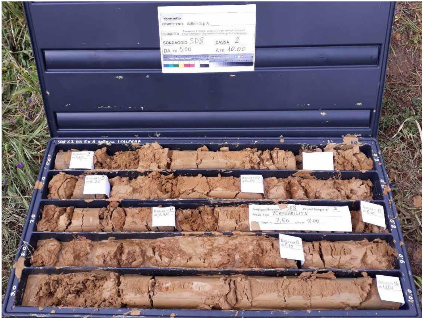
Foto 2 – Formazione Sabbie e ghiaie di Villaggio San Giorgio (GII) nel foro di sondaggio SD08, tra i 5.0 ed i 10.0 m dal p.c..
