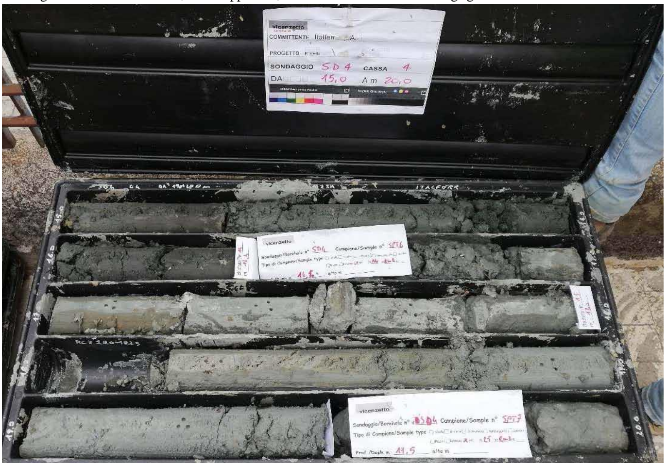
Foto 3 – Facies psammitica dei Depositi alluvionali antichi ( bn2 ) nel foro di sondaggio SD04, tra i 15.0 ed i 20.0 m dal p.c..
