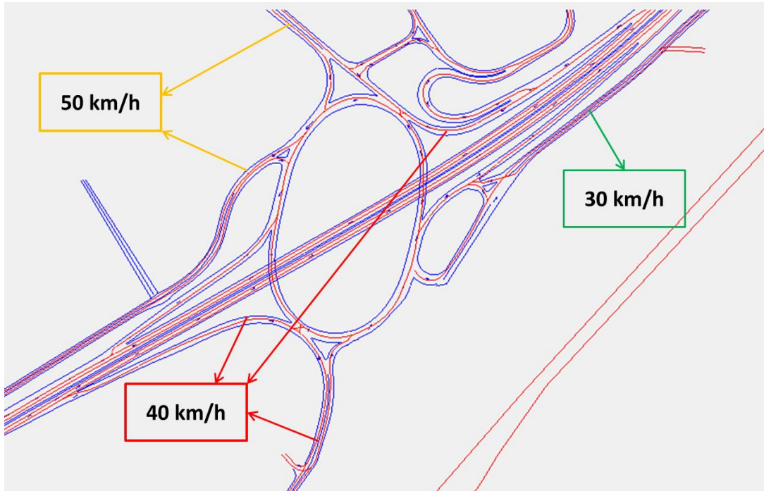
Figura 9 - Schema di rete dello scenario di cantiere con indicazione delle velocità
