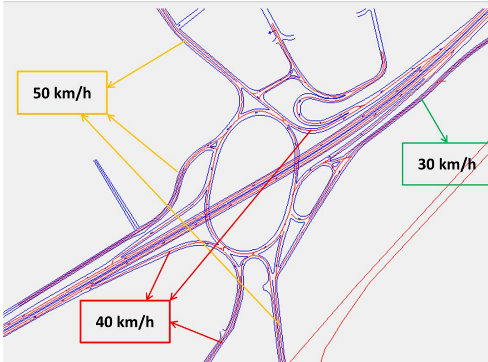
Figura 7 – Schema di rete dello scenario attuale con indicazione delle velocità e dei bracci
