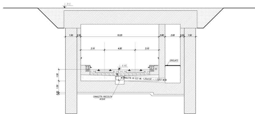
SEZIONE TIPO DRENAGGIO IMBOCCO GALLERIA LATO CT
