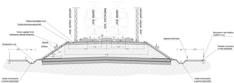
SEZIONE TIPO DRENAGGIO - RILEVATO
