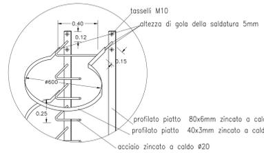
**PARTICOLARE TUBO IN ACCIAIO Ø400-SP. MM. 5.40**
