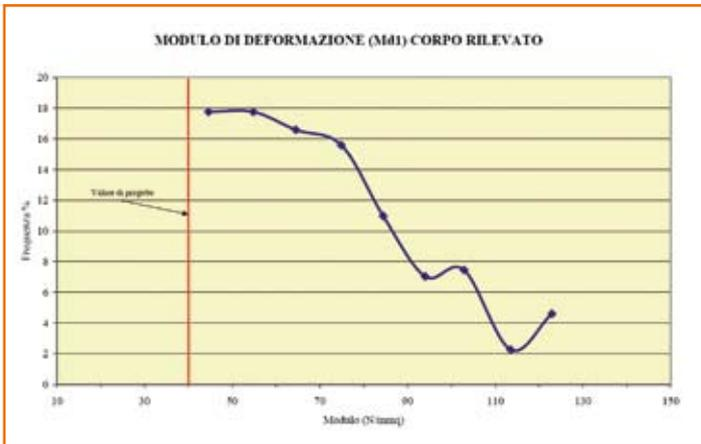
Figura 28 - Andamento modulo di deformazione nel corpo del rilevato
