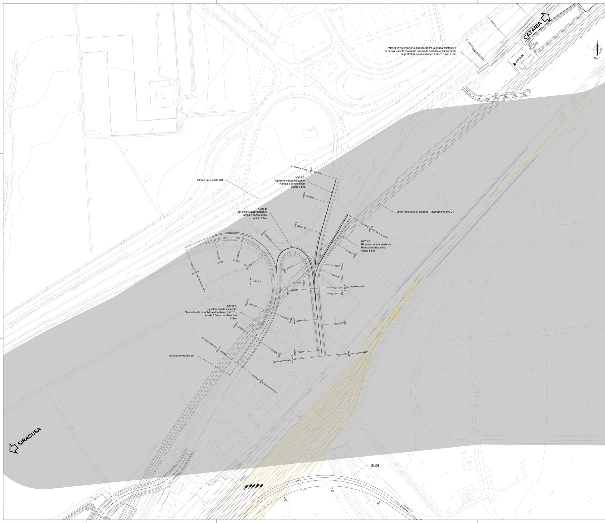
Tratto di pavimentazione di raccordo tra la strada esistente e la nuova viabilità realizzato tramite la scarifica e il rifacimento degli strati di usura e binder, L=25m e A=171mq
