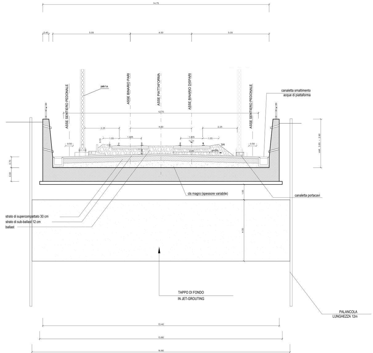
NOTA: Nella zona in cui la falda interferisce con la realizzazione del solettone di fondazione della trincea, si prevede l'aggettamento delle acque con un sistema di pompe centrifughe autoadescenti.
