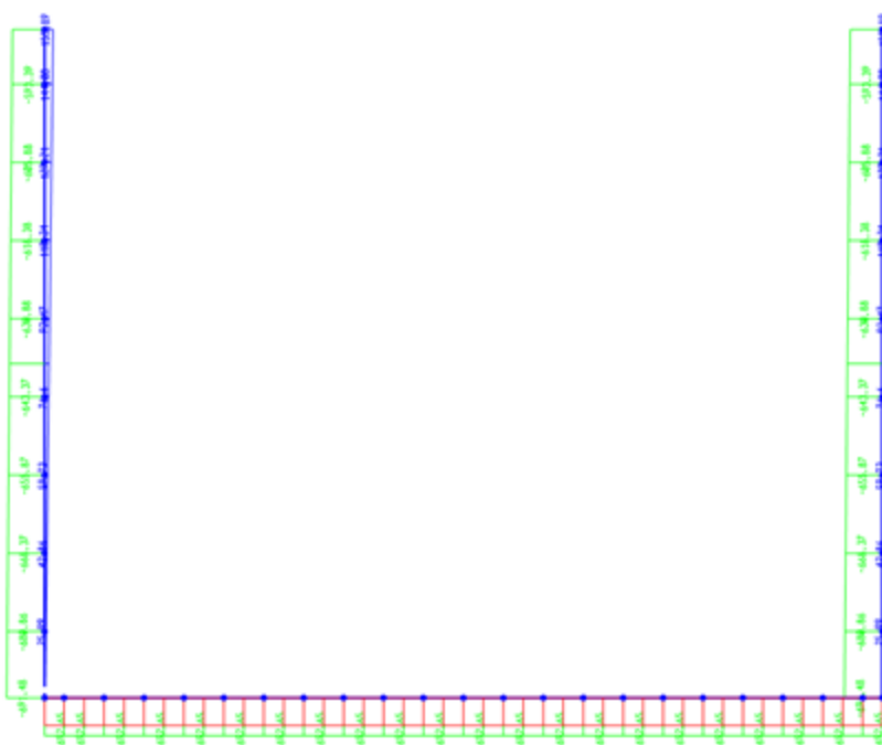
Figura 39. Involuppo Sforzo normale – SLU
