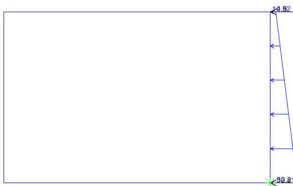
Figura 11 – Spinta del terreno sul piedritto destro.
