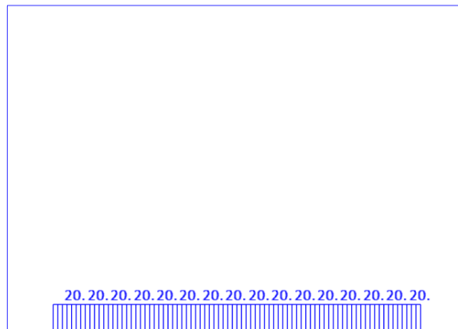
Figura 25 – Sovraccarico accidentale sulla soletta inferiore in posizione centrata.
