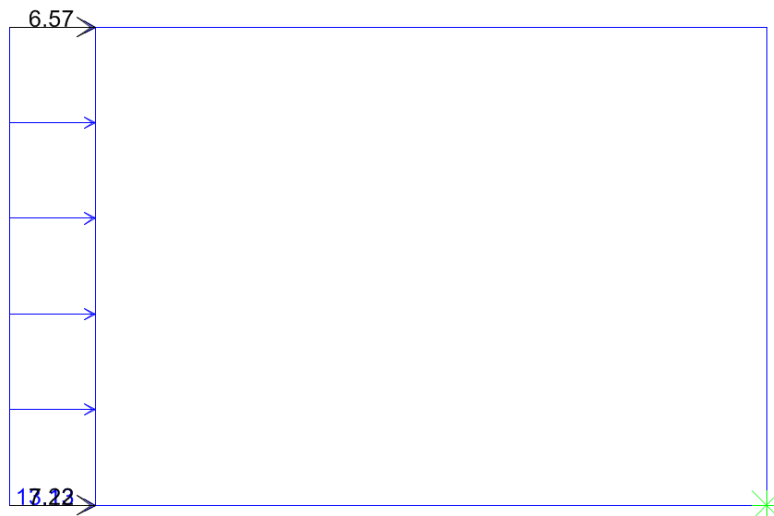
Figura 19 – Incremento di spinta sul piedritto sinistro dovuto al treno di carico LM71.
