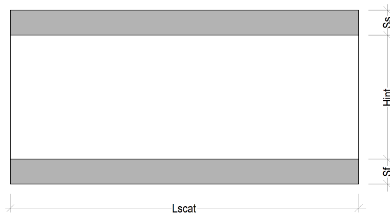
Figura 1. Sezione longitudinale dello scatolare
