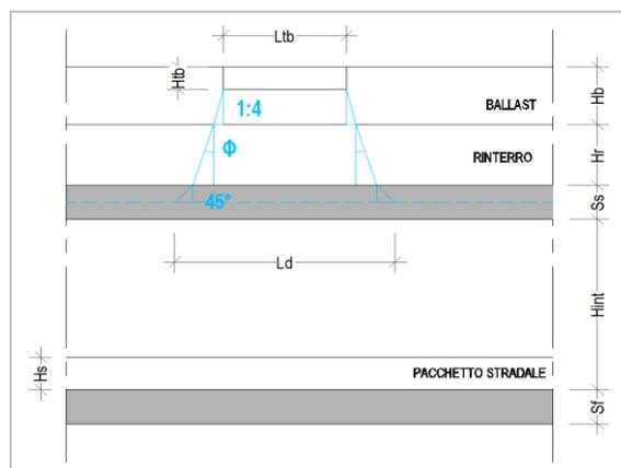
Figura 9. Schema modalità di diffusione dei carichi ferroviari
