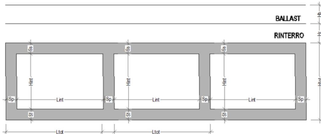
Figura 2. Sezione trasversale dello scatolare
