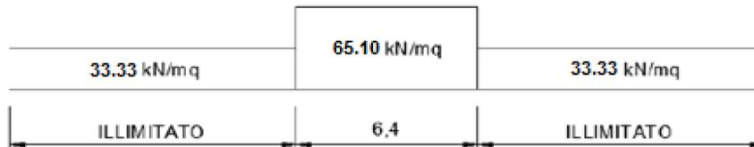
In conclusione nell'opera in oggetto la ripartizione del carico a quota del piano di regolamento è stata effettuata considerando una distribuzione in senso trasversale secondo una pendenza di 1 a 4 all'interno del ballast per cui risulta:
