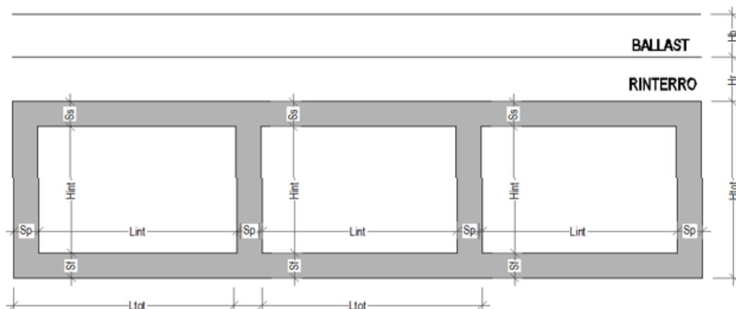
Figura 2. Sezione trasversale dello scatolare
