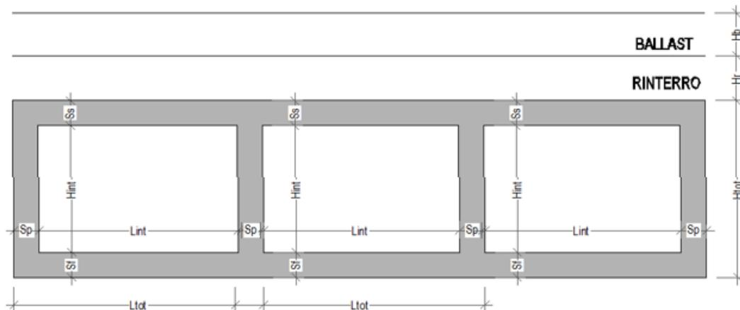
Figura 2. Sezione trasversale dello scatolare
