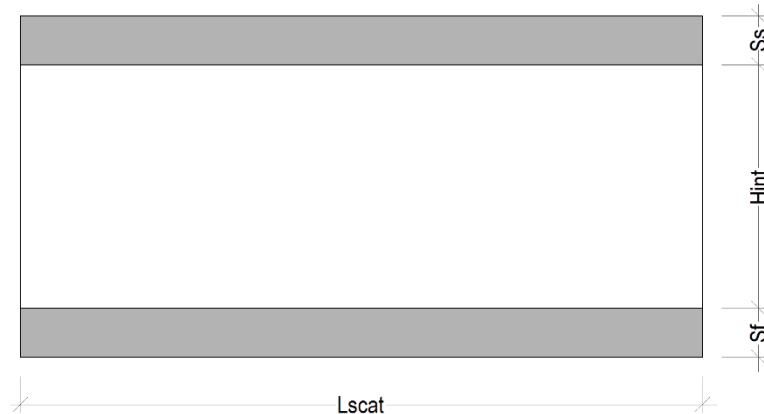
Figura 1. Sezione longitudinale dello scatolare
