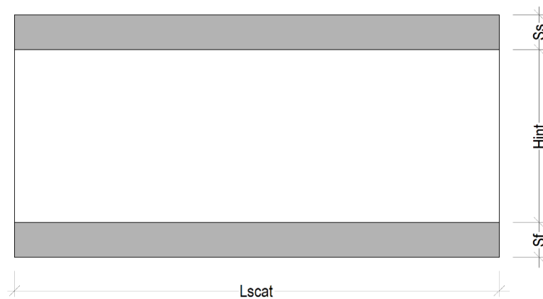
Figura 1. Sezione longitudinale dello scatolare
