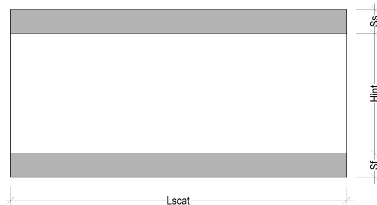
Figura 1. Sezione longitudinale dello scatolare
