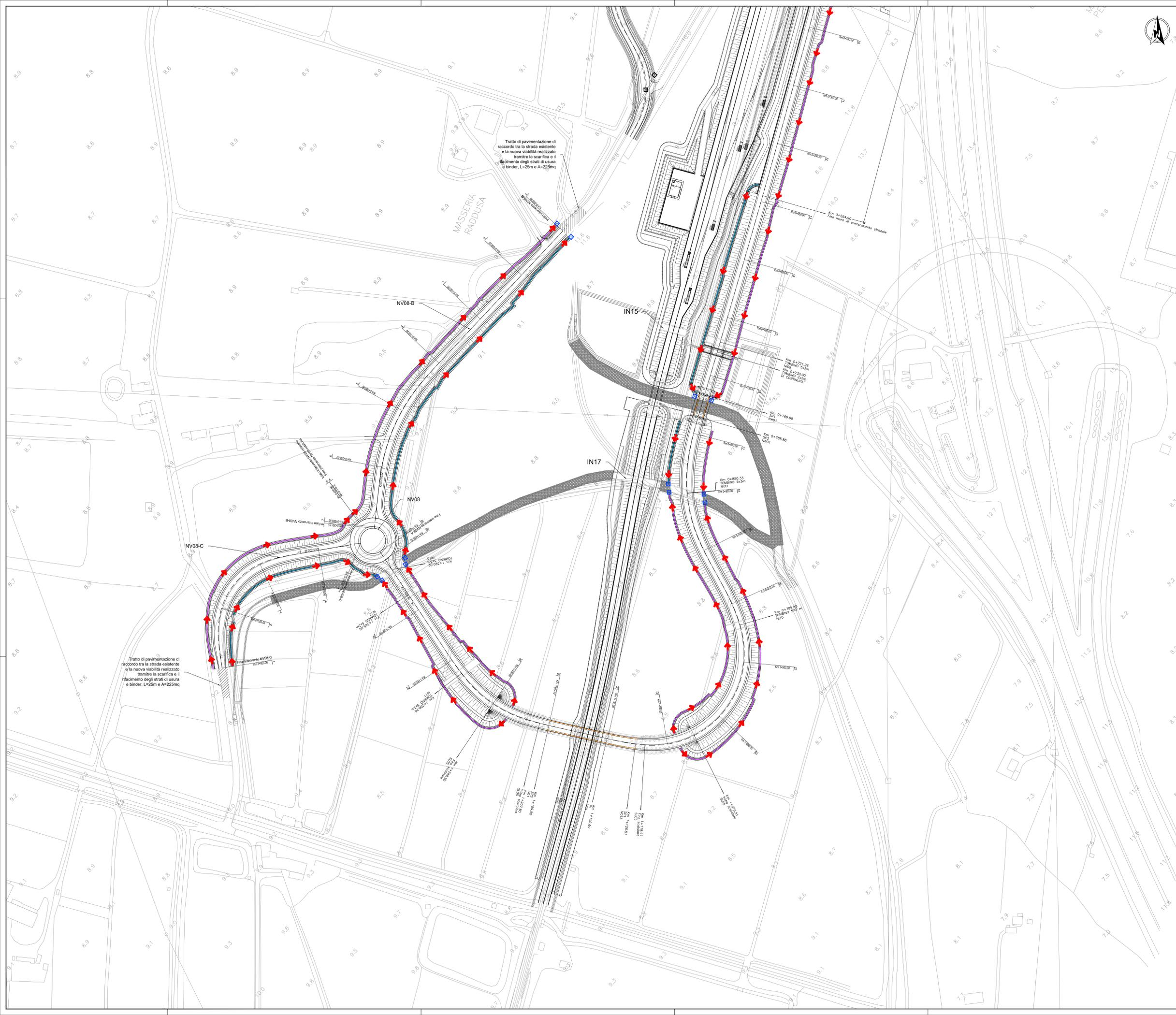
Tratto di pavimentazione di raccordo tra la strada esistente e la nuova viabilità realizzato tramite la scarifica e il rifacimento degli strati di usura e binder, L=25m e A=225mq
