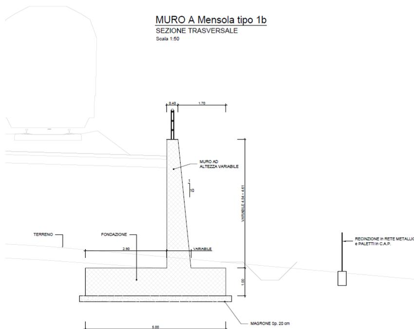
Figura 1-3 – Sezione MU06 tipo-b.
