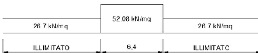
Pertanto il carico in corrispondenza del piano orizzontale alla quota della testa dell'opera di sostegno calcolato con il modello di calcolo LM71 risulta pari a:
