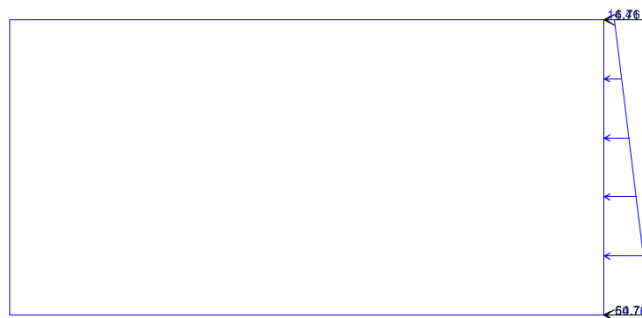
Figura 9 – Spinta del terreno sul piedritto destro.
