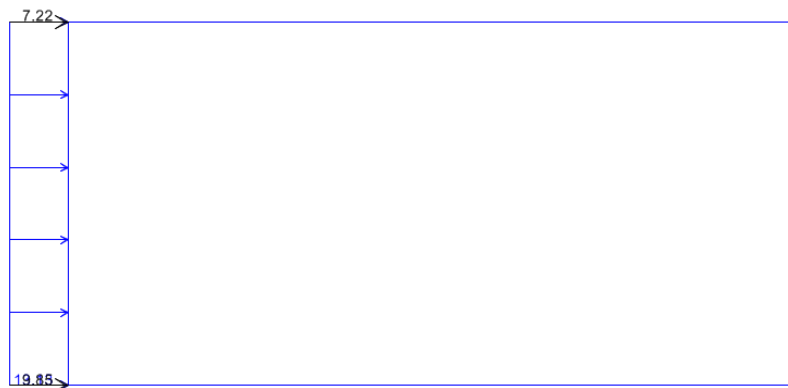
Figura 16 – Incremento di spinta sul piedritto sinistro dovuto al treno di carico LM71.
