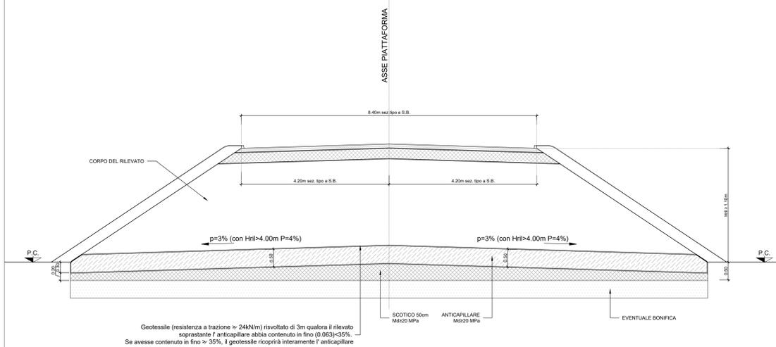
Sezione tipo in rilevato - Piano di posa inclinato con  $p > 15\%$
