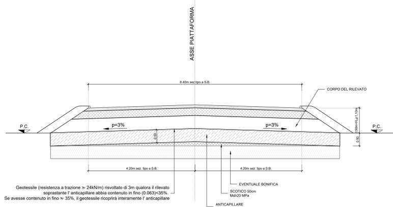
Sezione tipo in rilevato -  $H_{ri} \geq 1,10$  m
