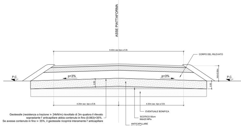
Sezione tipo in rilevato -  $0,90m < H_{ri} \leq 1,10$  m
