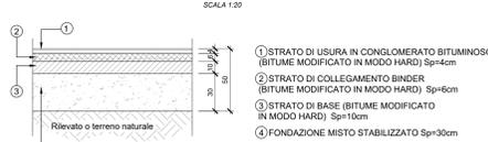
**DETTAGLIO PAVIMENTAZIONE STRADALE TIPO 2 Categoria strada a destinazione particolare 4.00m - 6.50m**
