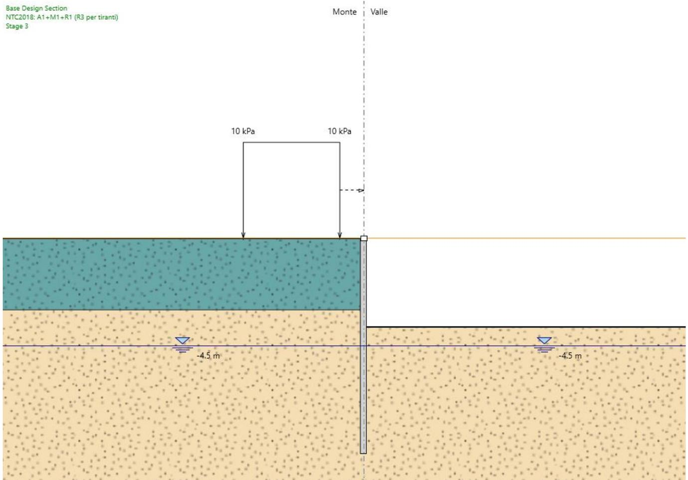
Figura 8 \_ Modello di calcolo – Fase 3.
