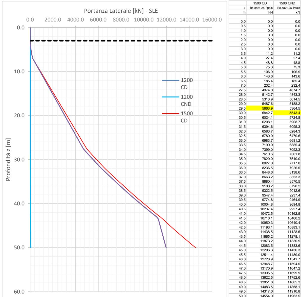
Figura 7 \_ Curva di capacità portante.
