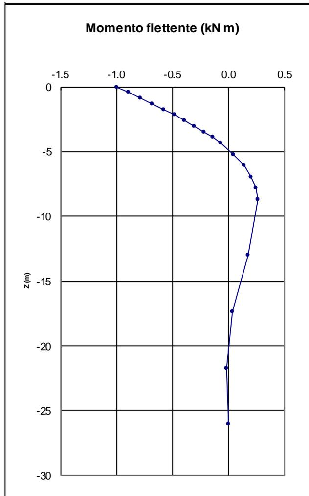
Figura 4 \_ Andamento del momento flettente lungo lo sviluppo del palo.
