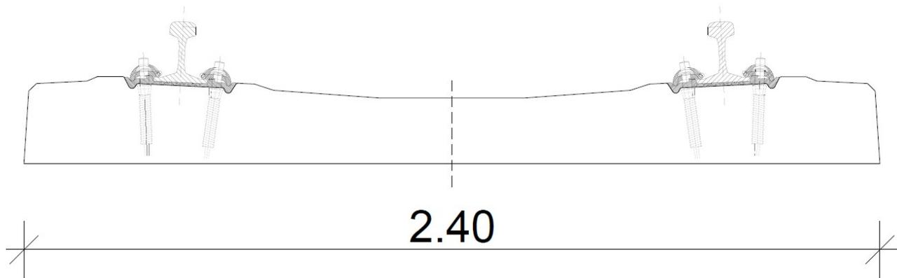
Il binario sarò armato con traverse tipo RFI 240 di lunghezza 2,40 m dotata di attacco di tipo elastico conforme alle Specifiche Tecniche RFI con scartamento di 1435 m.
