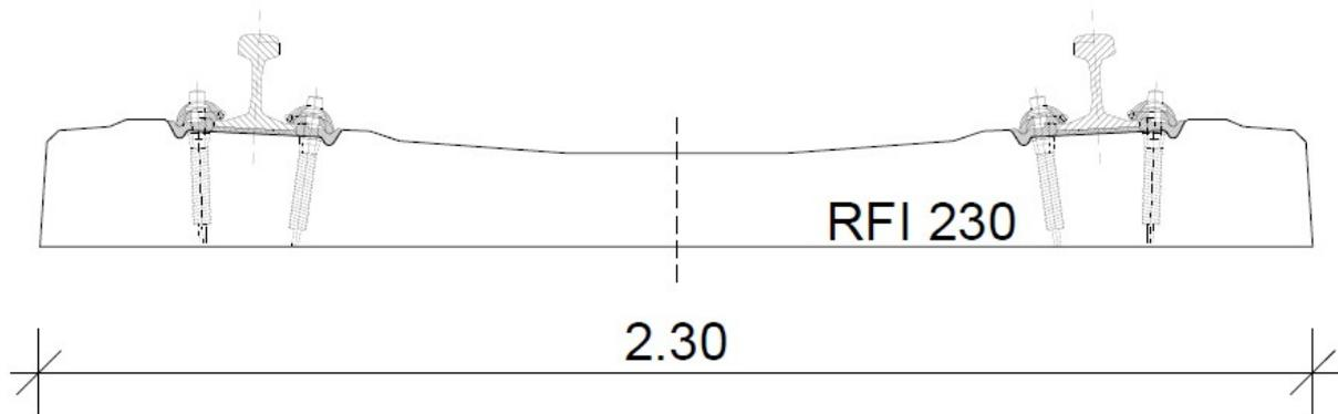
Il binario sarò armato con traverse tipo RFI 230 di lunghezza 2,30 m dotata di attacco di tipo elastico conforme alle Specifiche Tecniche RFI con scartamento di 1435 m.
