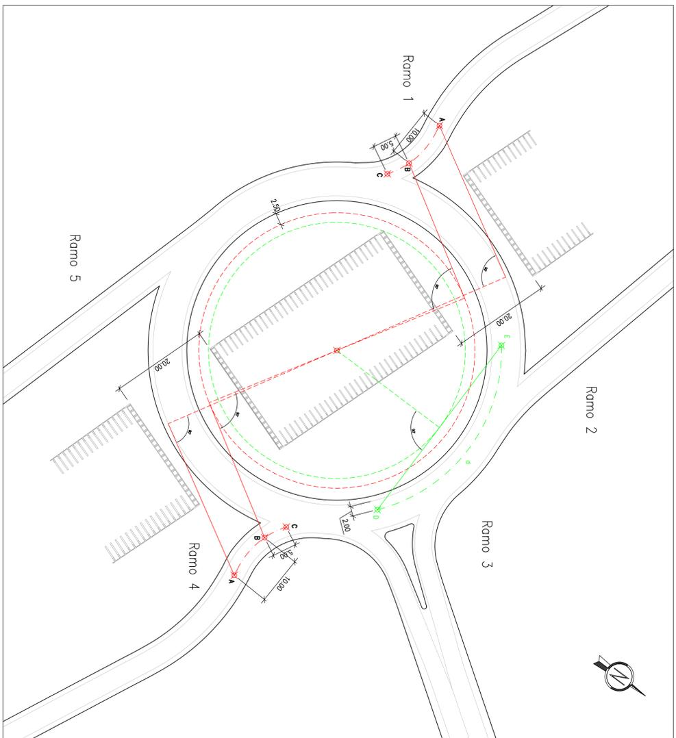
Le verifiche di visibilità sulle rampe di ingresso e della geometria di deflessione delle tratte, in ingresso e uscita, sono state condotte secondo i dettami del paragrafo 4.6 del DM 19.4.06 (in rosso e in blu).
