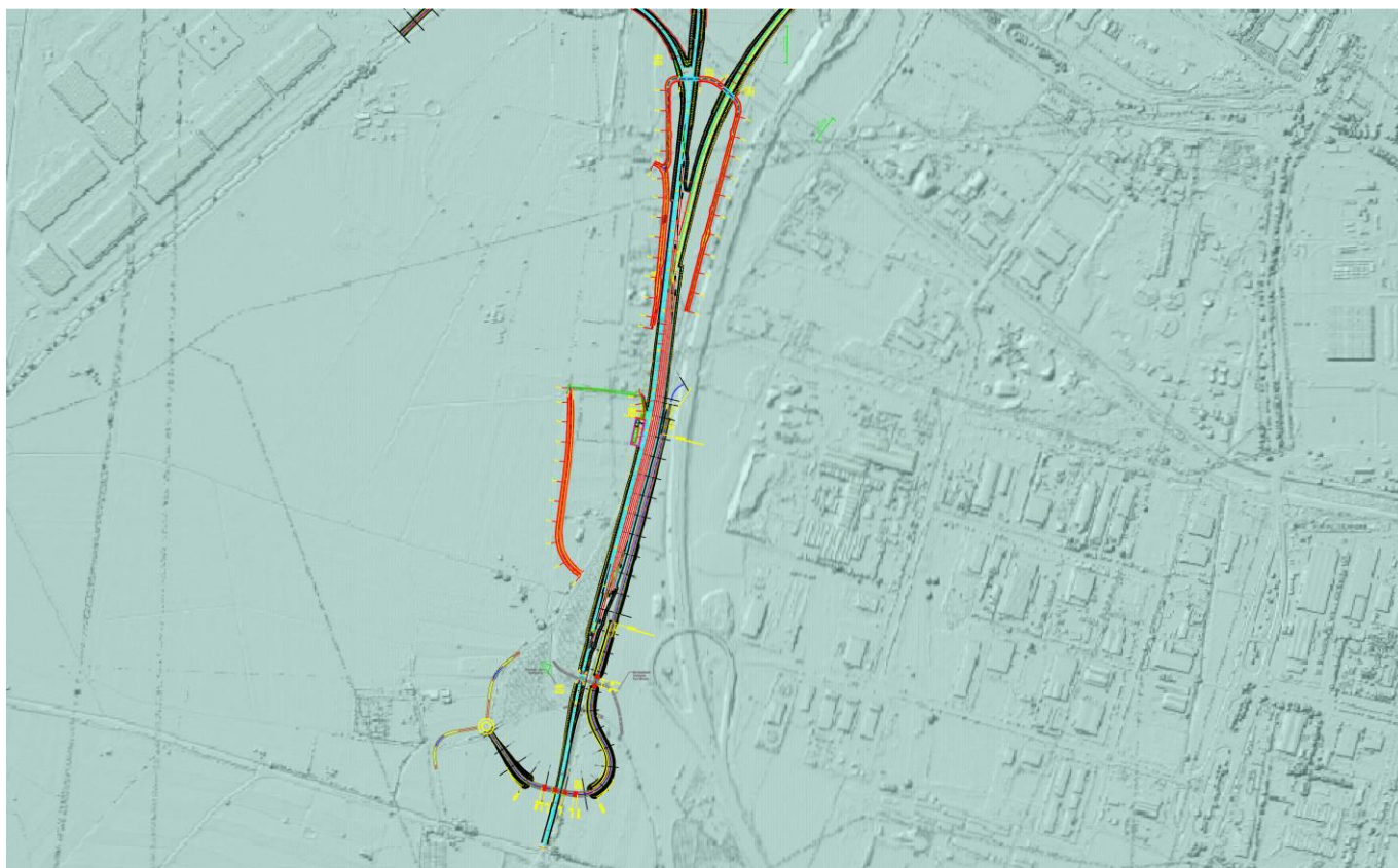
Figura 19 – Elaborazione LiDAR di una porzione dell’area interessata dai lavori, con sovrapposizione del progetto.
