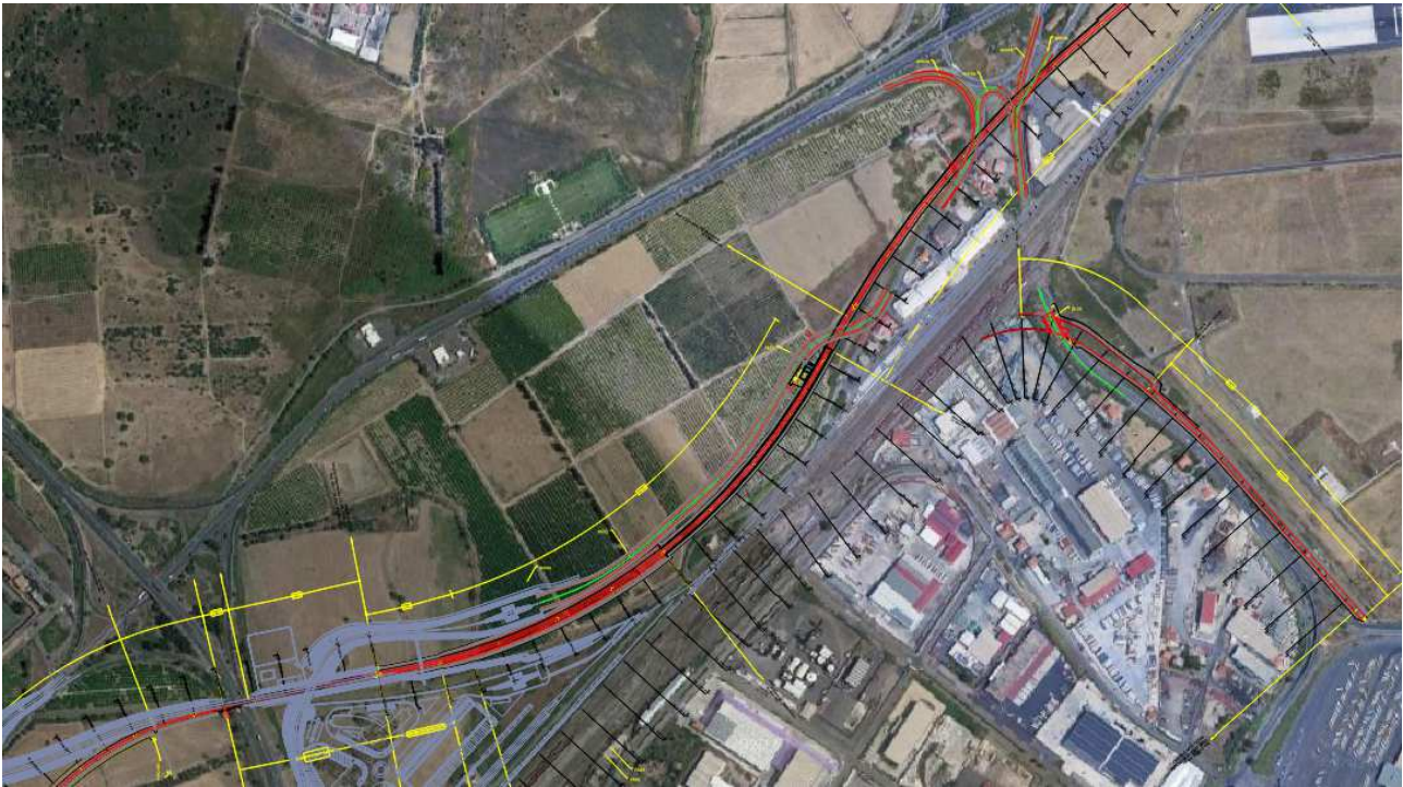
Figura 3-3 – Inquadramento della galleria artificiale.
