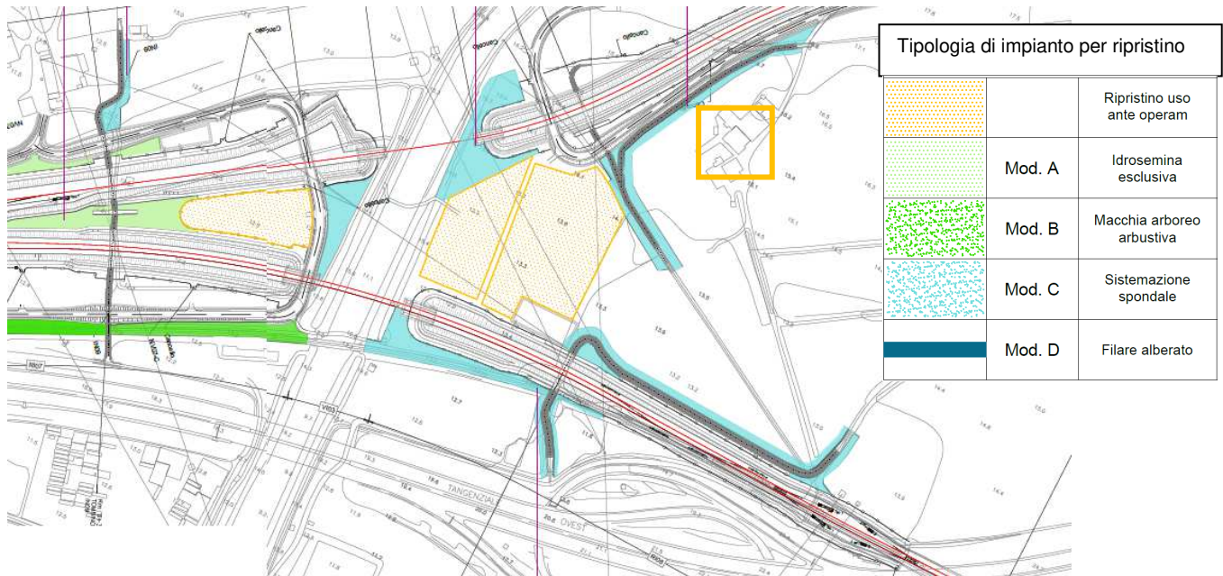
Figura 5-11- Soluzioni di ripristino per il tratto del Lotto 2 ricadente in aree soggette a vincolo (art. 142, let. "c" del D.Lgs 42/2004). In arancione viene messa in evidenza la Masseria Pace, prossima al rilevato di nuova realizzazione.
