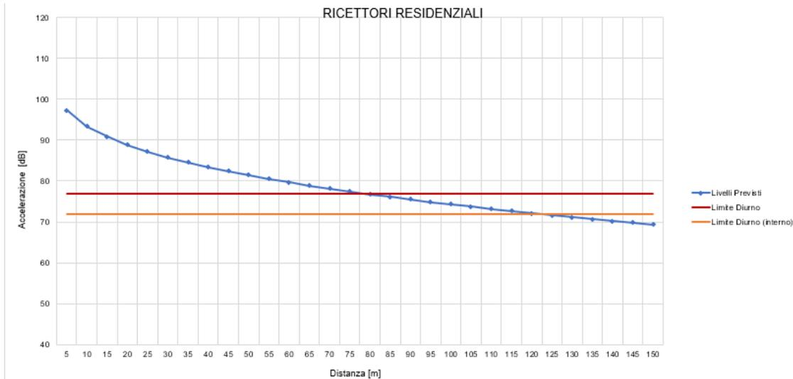
**Figura 6-18 – Propagazione dei livelli di accelerazione stimati sui ricettori residenziali per lo scenario cantiere rilevato con rullatura**
