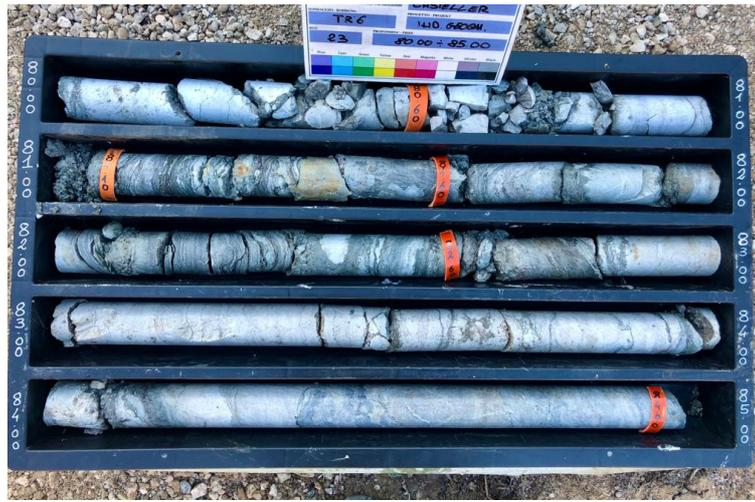
**Figura 20. Dolomie del Serla Inferiore (SLI) nel foro di sondaggio TN6**
