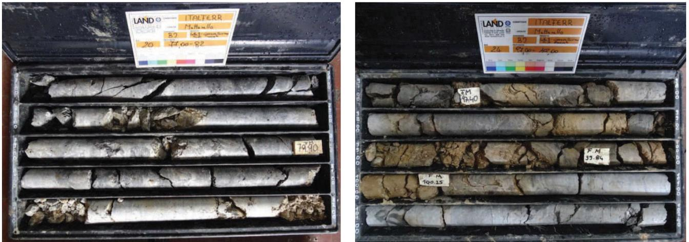
Figura 11. Gruppo dello Zwischenbildungen (ZW) nel foro di sondaggio B2
