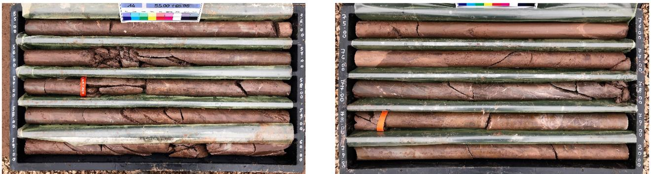
**Figura 22. Arenarie della Val Gardena (GAR) nel foro di sondaggio TN4**
