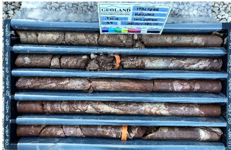
**Figura 21. Formazione a Bellerophon (BEL) nel foro di sondaggio TN4**
