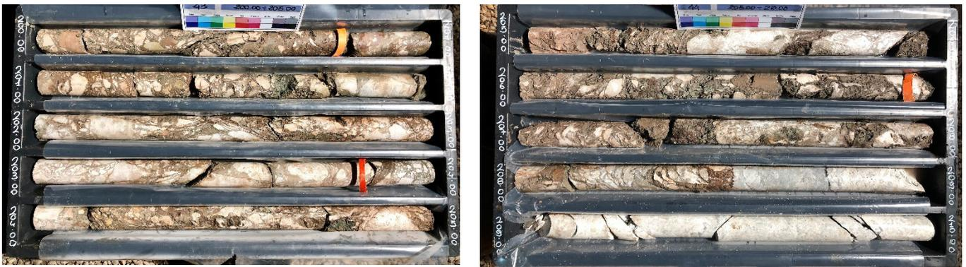
**Figura 27. Zona di faglia Trento-Roncogno nel foro di sondaggio TN4**
