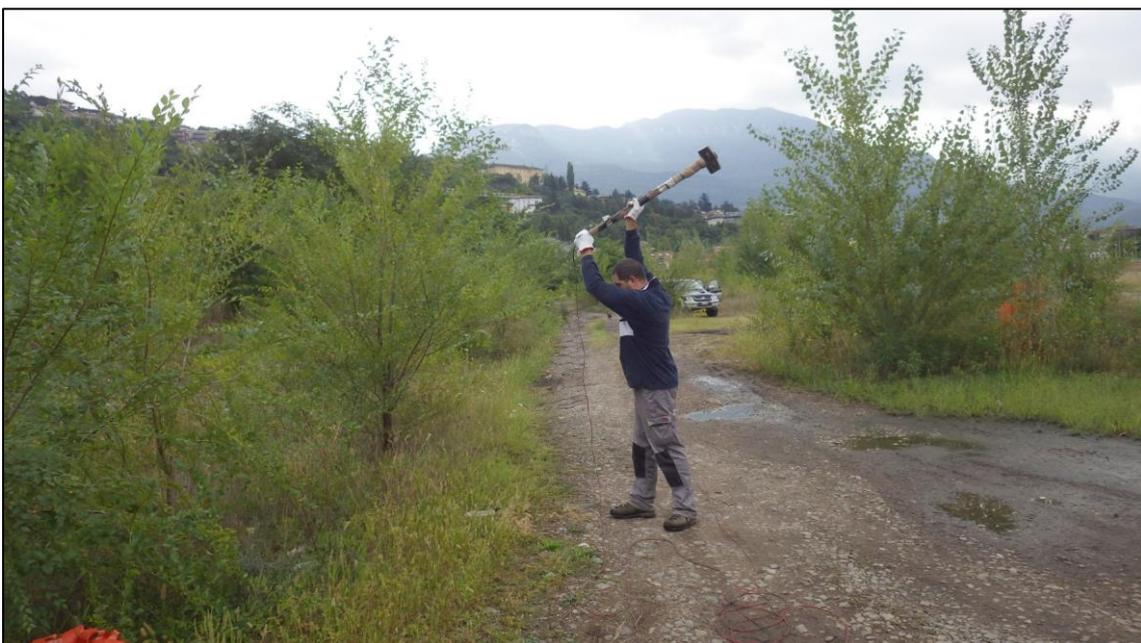
Fig. 3 – Punto di energizzazione durante una delle prove M.A.S.W..
