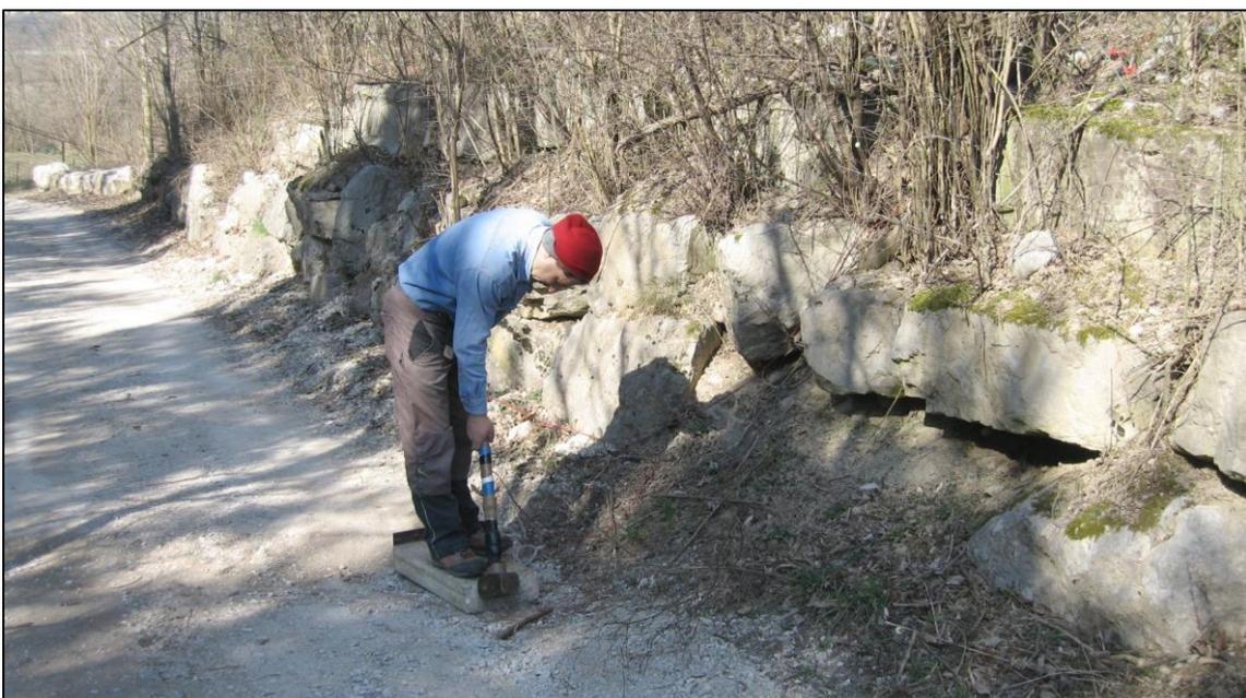
**Fig. 5 – Punto di energizzazione in onde S lungo uno dei profili sismici a rifrazione eseguiti.**
