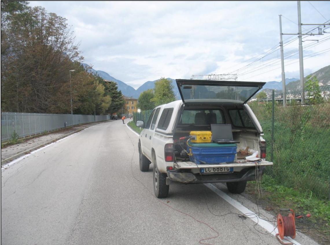
Fig. 2 – Apparecchiatura di registrazione durante una delle prove M.A.S.W..
