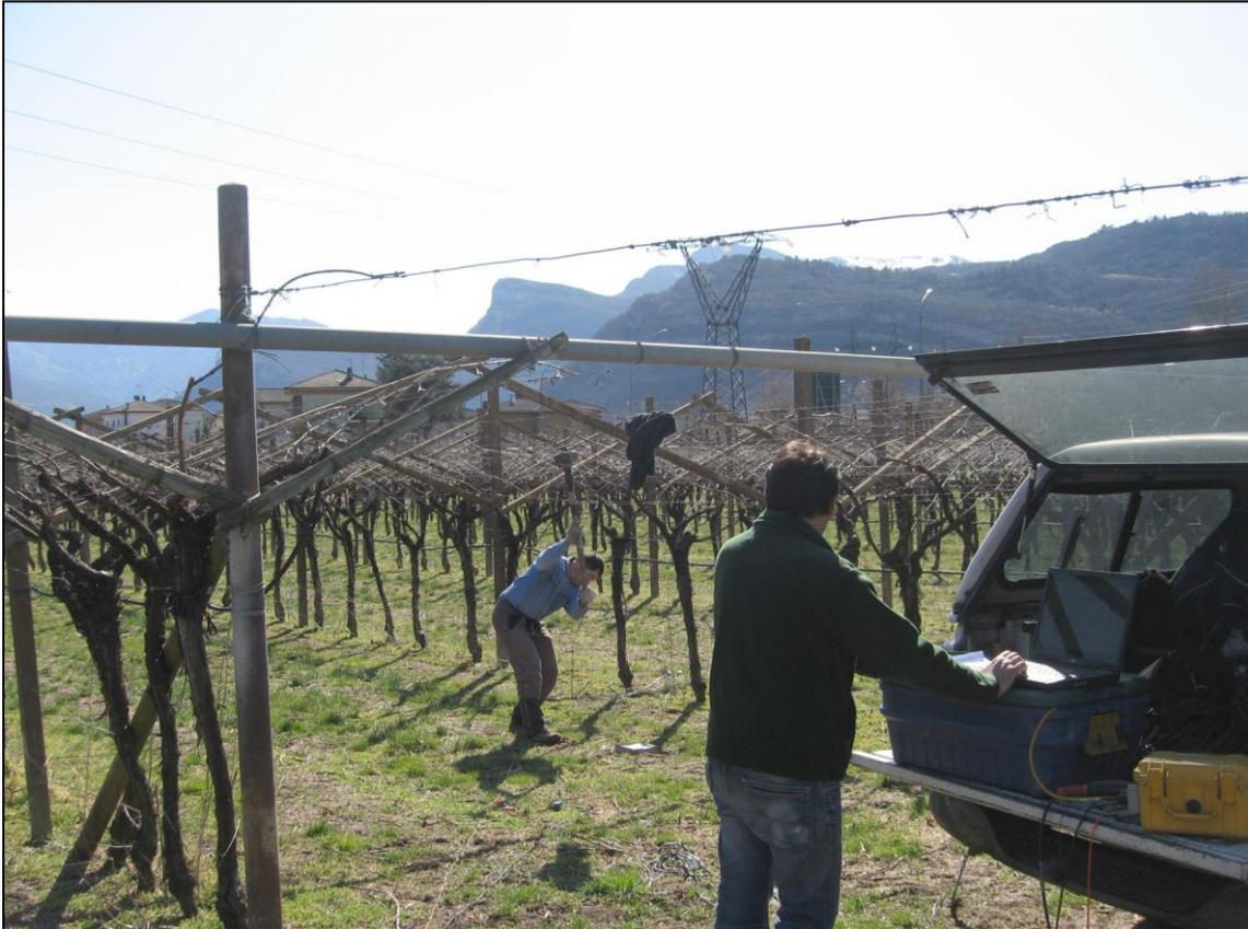
**Fig. 4 – Punto di energizzazione in onde P lungo uno dei profili sismici a rifrazione eseguiti.**
