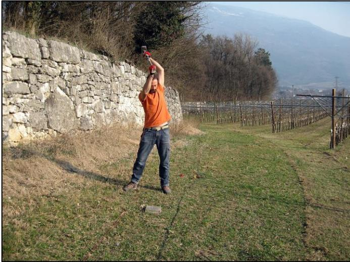
In punti predefiniti del profilo, solitamente ogni 4 geofoni, sono stati creati artificialmente degli impulsi elastici mediante l'utilizzo di una massa battente da 8.0 Kg; per ogni punto di energizzazione, per migliorare il rapporto segnale-rumore, sono state sommate diverse battute. Il “time-break”, tempo zero di inizio registrazione, è stato fissato attraverso l’apertura di un circuito elettrico posizionato sulla massa battente.
