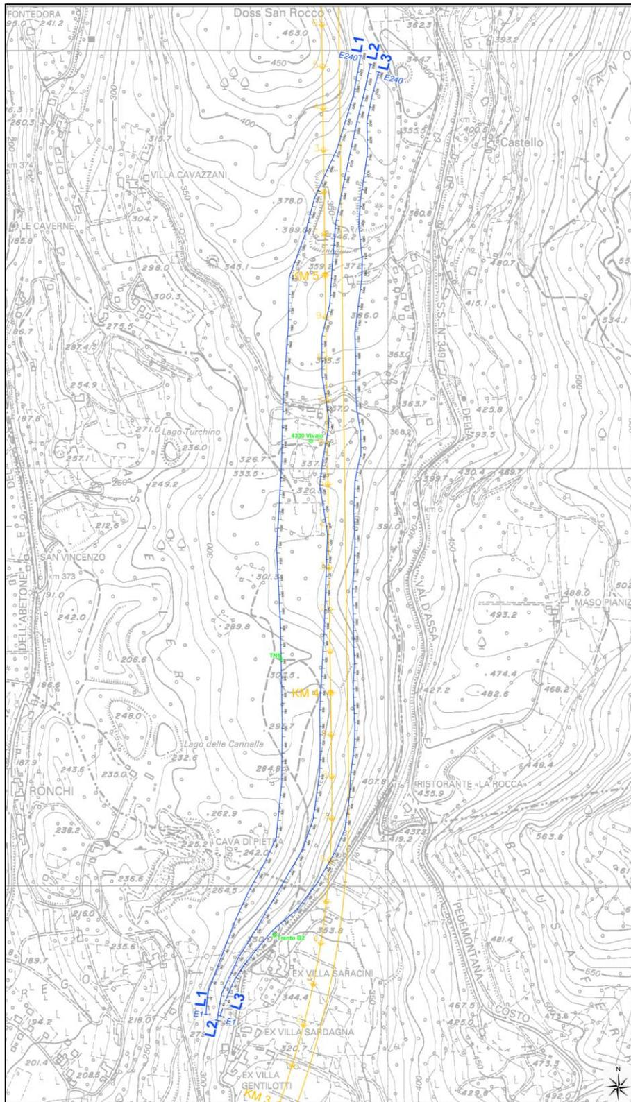
**Fig. 3 - Estratto planimetrico delle indagini eseguite – Zona Riserva del Casteller: in blu gli stendimenti tomografici elettrici (L1, L2 e L3) e in verde i sondaggi geognostici. In giallo è indicato il tracciato ferroviario in progetto.**
