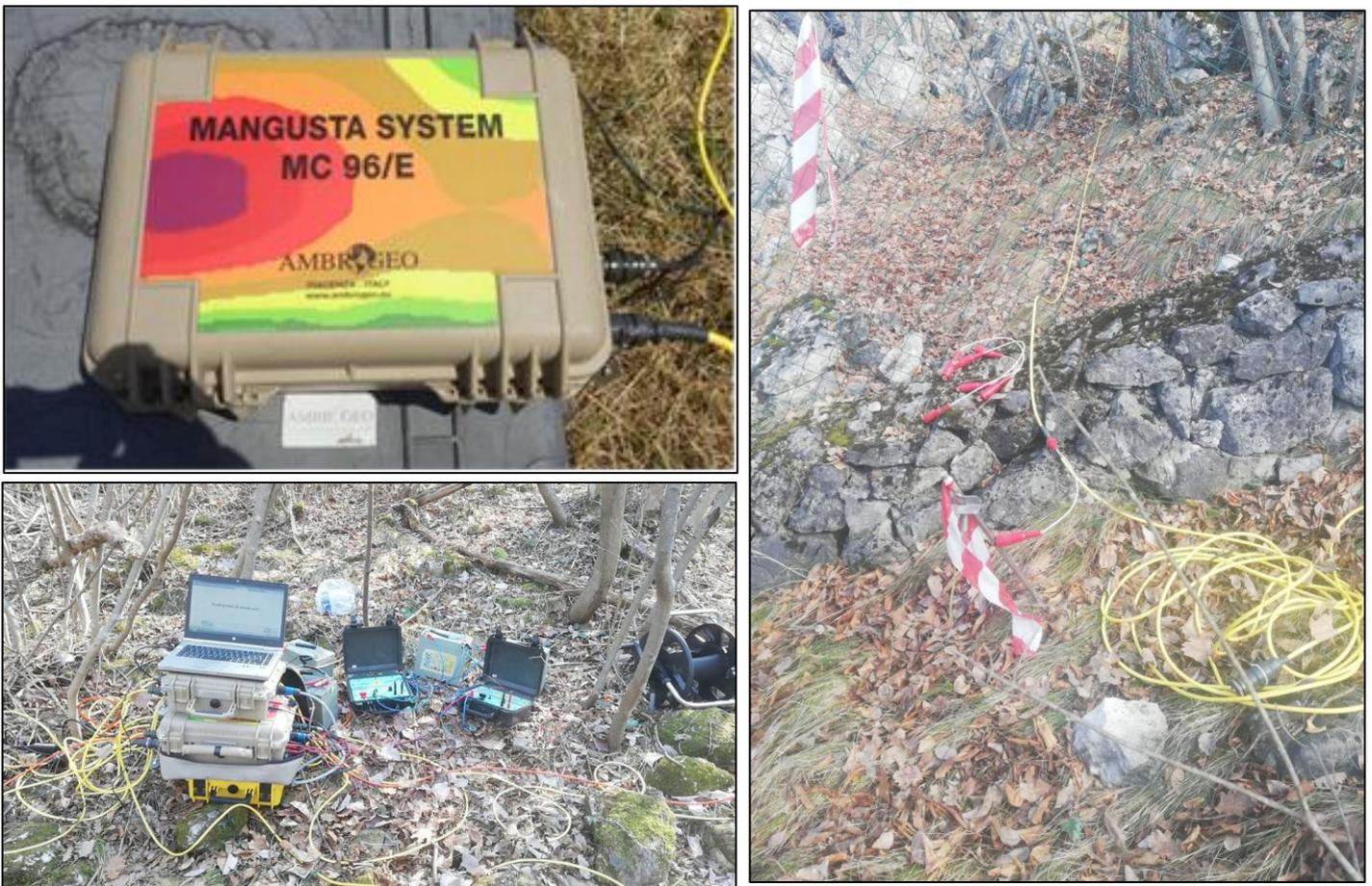
Fig. 7 - Georesistivimetro digitale del tipo MANGUSTA SISTEM MC (a sinistra in alto), strumentazione utilizzata in fase di acquisizione (a sinistra in basso) e particolare di elettrodo passivo posizionato su picchetto metallico (a destra).
